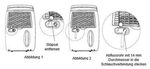
Um einen kontinuierlichen Abfluss zu ermöglichen, ziehen Sie den Stopfen von der Rückseite des Geräts ab und schieben Sie den 14-mm-Schlauch durch das Loch, durch das er am internen Abflussrohr befestigt wird (damit ein kontinuierlicher Abfluss funktioniert, muss der Wassertank stets befestigt sein).
