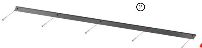
Montieren Sie die Halterung (Abbildung 2) an der Wand, indem Sie die fünf (im Lieferumfang enthaltenen) Schrauben in den Wandlöchern befestigen.
