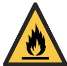
To urządzenie wykorzystuje łatwopalny czynnik chłodniczy. Jeżeli czynnik chłodniczy wycieknie i wejdzie w kontakt z ogniem lub elementem grzewczym, dojdzie do wytworzenia szkodliwego gazu i zaistnieje ryzyko pożaru.
