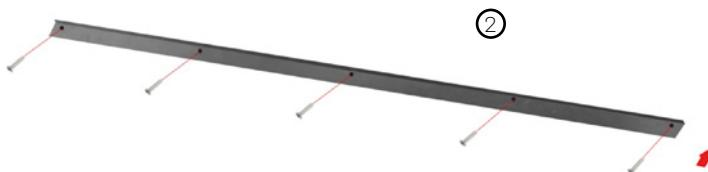
Należy zamontować wspornik (Rysunek 2) do ściany, przykręcając pięć śrub (w zestawie) do otworów w ścianie.
